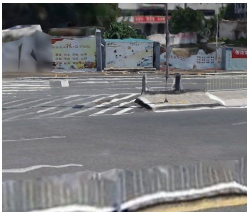
图4 栅栏、指示牌等出现扭曲变形
